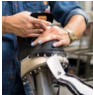
5 INSERIMENTO MEMBRANA WATER SHIELD Insertion de la membrane Water Shield / Inserción de la membrana de protección Water Shield
